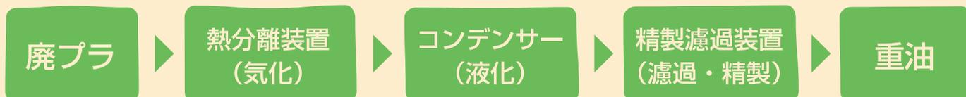
当社の廃プラ油化装置はバッチ式熱分離式を採用しており、廃プラを加熱炉に投入400℃まで熱し気化、コンデンサーで冷やされ液化し、精製濾過装置で濾過されて重油が精製されます。
